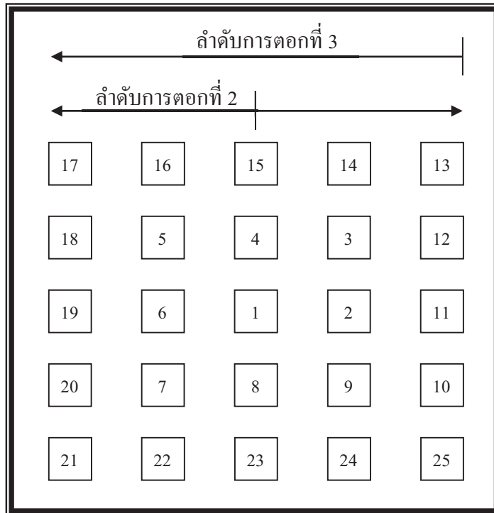
รูปที่ 6 ตัวอย่างลำดับการตอกกลุ่มเสาเข็ม (ข้อ 5.3.15)
